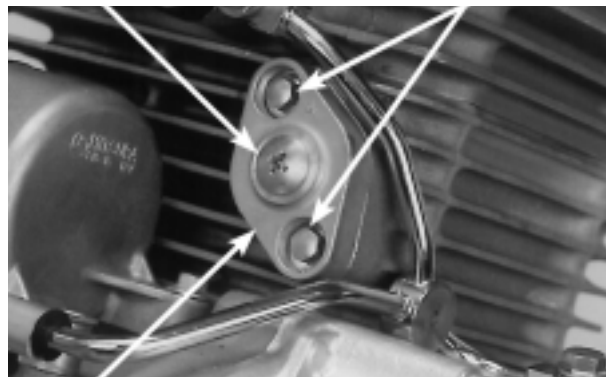
ACCIONADOR DEL TENSOR/JUNTA
