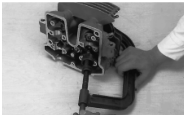
COMPRESOR DEL RESORTE DE VÁLVULAS/ACCESORIO VÁLVULA ASIENTO DEL RESORTE
